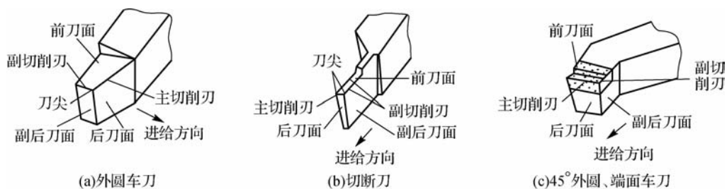
图 5-24 车刀切削部分的组成
