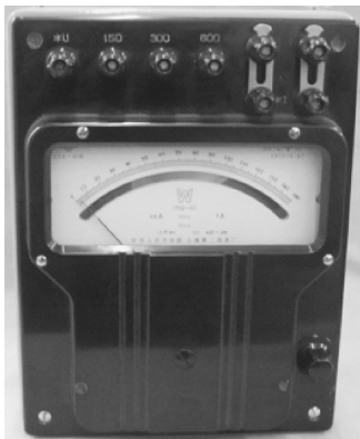
图 2-12 D34-W 型低功率因数功率表的外形
