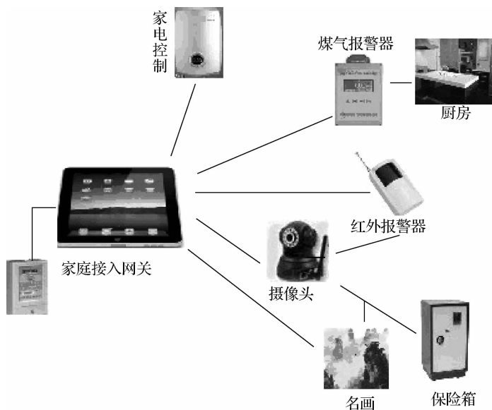
图 3-9 物联网网关在智能家居中的应用
