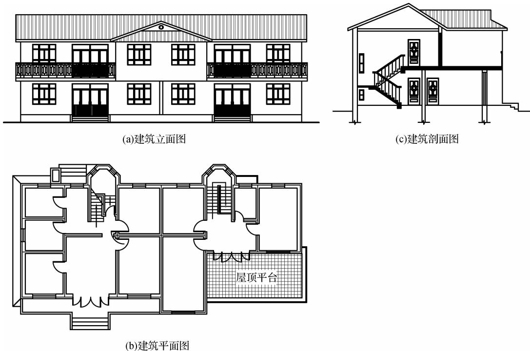
图 1-4 建筑立面图、平面图、剖面图
