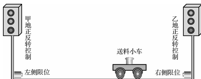
图 1-18 带限位的电动机正、反转运行
