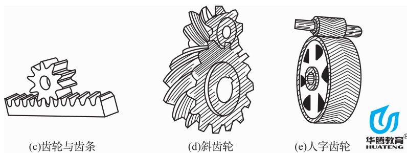
图 2-27 平行轴间传动的齿轮机构
