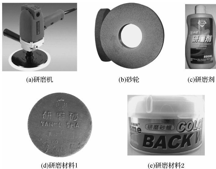
图 2-32 常用研磨工具
