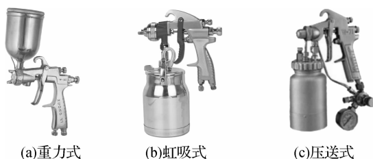
图 2-19 底漆喷枪类型
