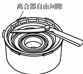
图 3-18 用塞尺测量离合器的自由间隙
