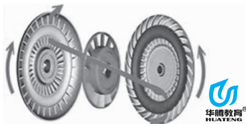
图 2-7 液力变矩器的工作原理
