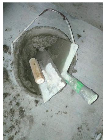
图 2-37 铁泥抹和托灰板
