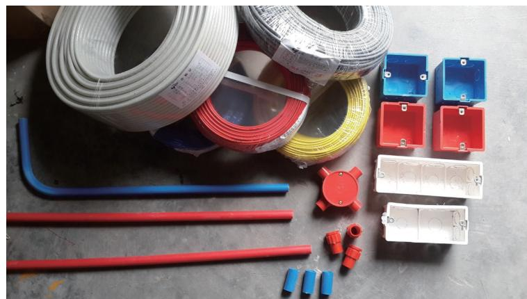
图 2-2 常用强弱电线材料
