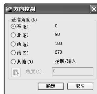
图 2-24 “方向控制”对话框
