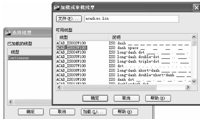
图 2-26 设置图层的线型
