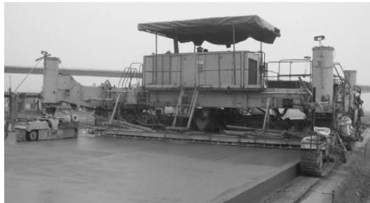
图 2-21 水泥混凝土滑模摊铺机
