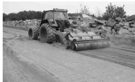
稳定土拌和机按行走系形式可分为履带式、轮胎式和复合式(履带与轮胎结合); 按牵引方式, 可分为自行式、半拖式和悬挂式; 按动力传动形式, 可分为机械式、液压式和混合式(机械、液压结合); 按工作装置(转子)在机械上的位置, 可分为中置式和后置式。
