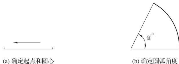
图 2-26 使用“起点、圆心、角度”的方式绘制圆弧
