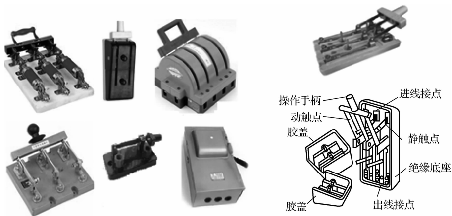
图 1-12 刀开关的外形与结构
