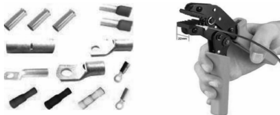
图 1-52 绝缘端子与压接操作
