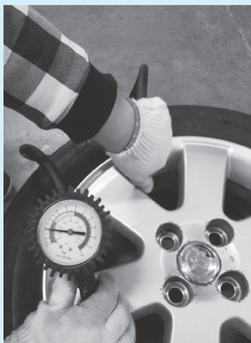
图 3-21 轮胎气压检查
