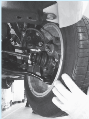
图 3-39 车轮与制动管路摩擦干涉检查
