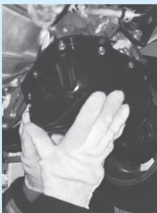
图 3-10 变速器油液泄漏检查
