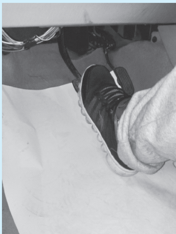
图 3-33 制动踏板响应性检查
