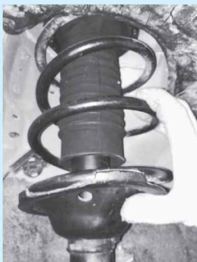
图 3-29 减振弹簧检查
