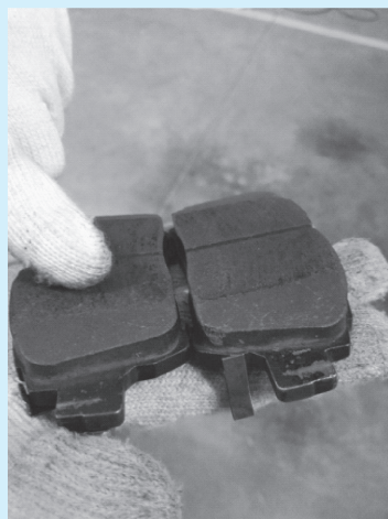
图 3-42 摩擦片磨损检查
