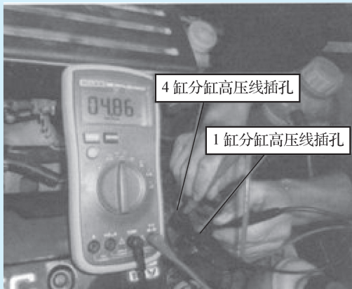
图 3-2 点火提前角检测的方法
