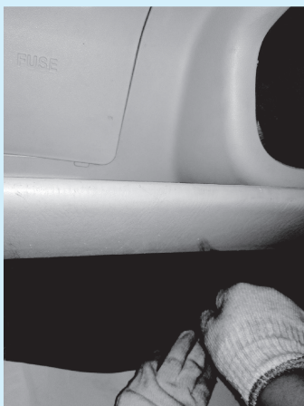
图 3-35 制动踏板自由行程检查
