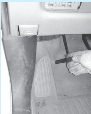
图 3-9 测量离合器踏板高度
