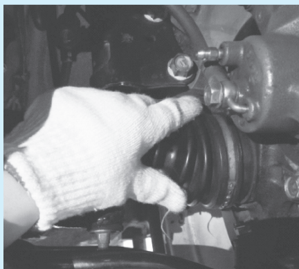
图 3-14 驱动轴护套检查
