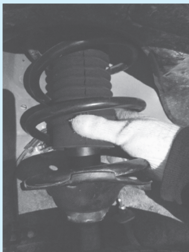
图 3-28 减振器漏油检查
