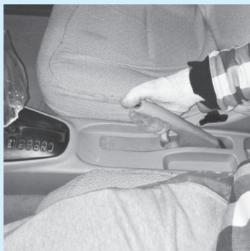
图 3-37 驻车制动器行程检查
