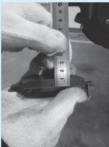
图 3-43 摩擦片厚度检查
