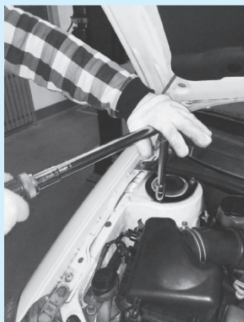
图 3-32 悬架上支撑螺栓检查
