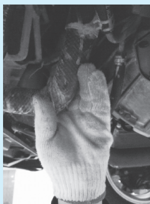
图 3-12 底部软管检查
