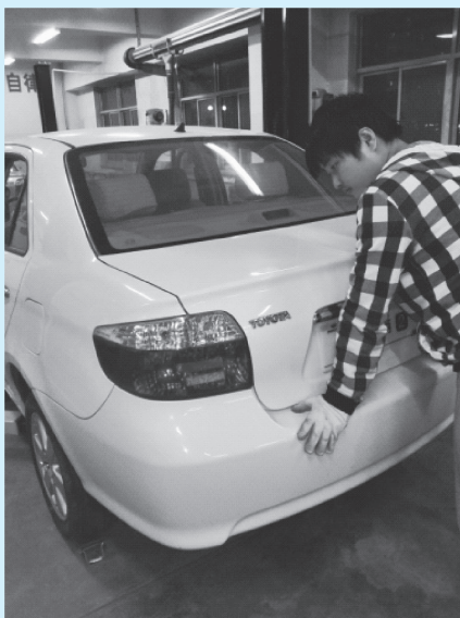
图 3-26 减振器减振检查
