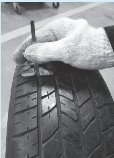
图 3-20 花纹沟槽深度检查
