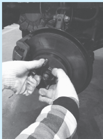
图 3-47 制动拖滞检查
