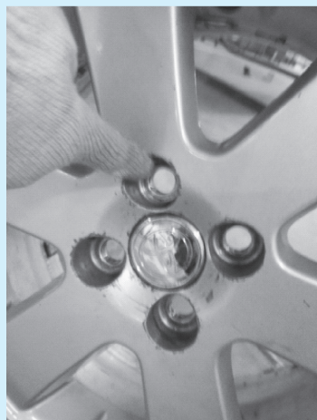
图 3-24 轮胎螺栓孔检查
