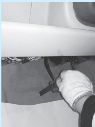
图 3-34 制动踏板高度检查
