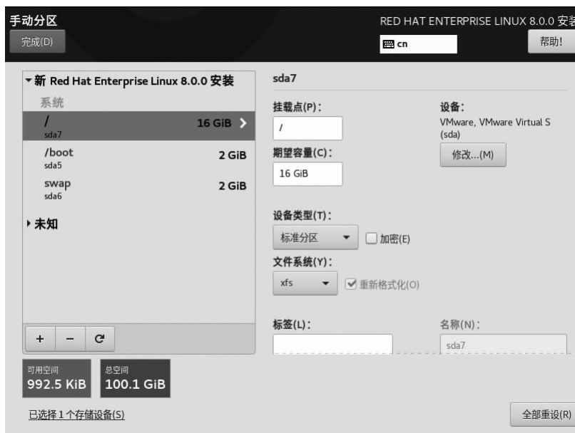
图 1-23 安装 Linux 系统的分区示意图
