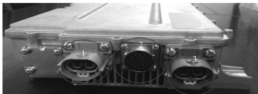
1—交流充电输入、交流放电输出; 2—低压接插件; 3—直流放电输出、直流充电输入。
