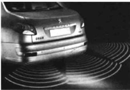
图 2-17 基于超声波传感器的泊车系统
