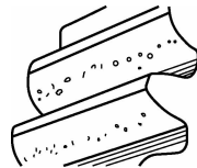
图 5-20 齿面疲劳点蚀
