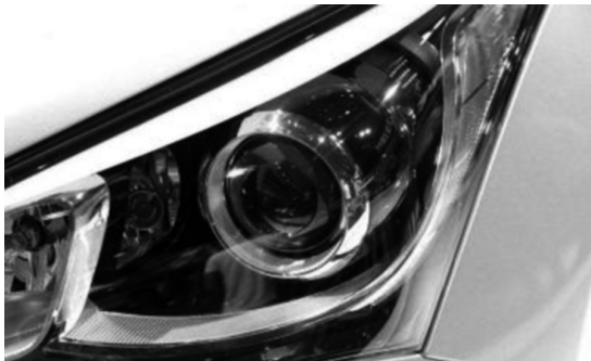
图 1-34 卤素灯实车安装
