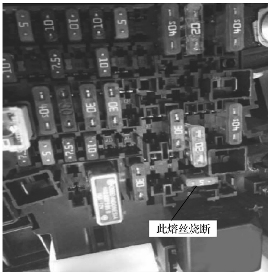
图 2-23 发动机机舱熔丝盒 SC49 熔丝烧断
