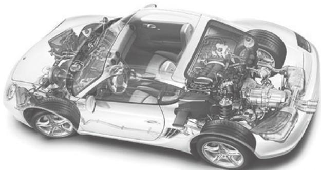
图 1-1 典型轿车的总体构造
