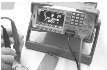
图 1-19 开尔文测试线清零
