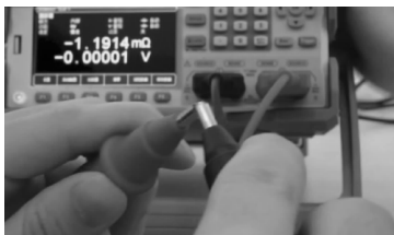
图 1-18 皇冠探头测试棒清零
