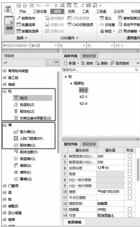
图 1-2 构件墙、柱的拆分
