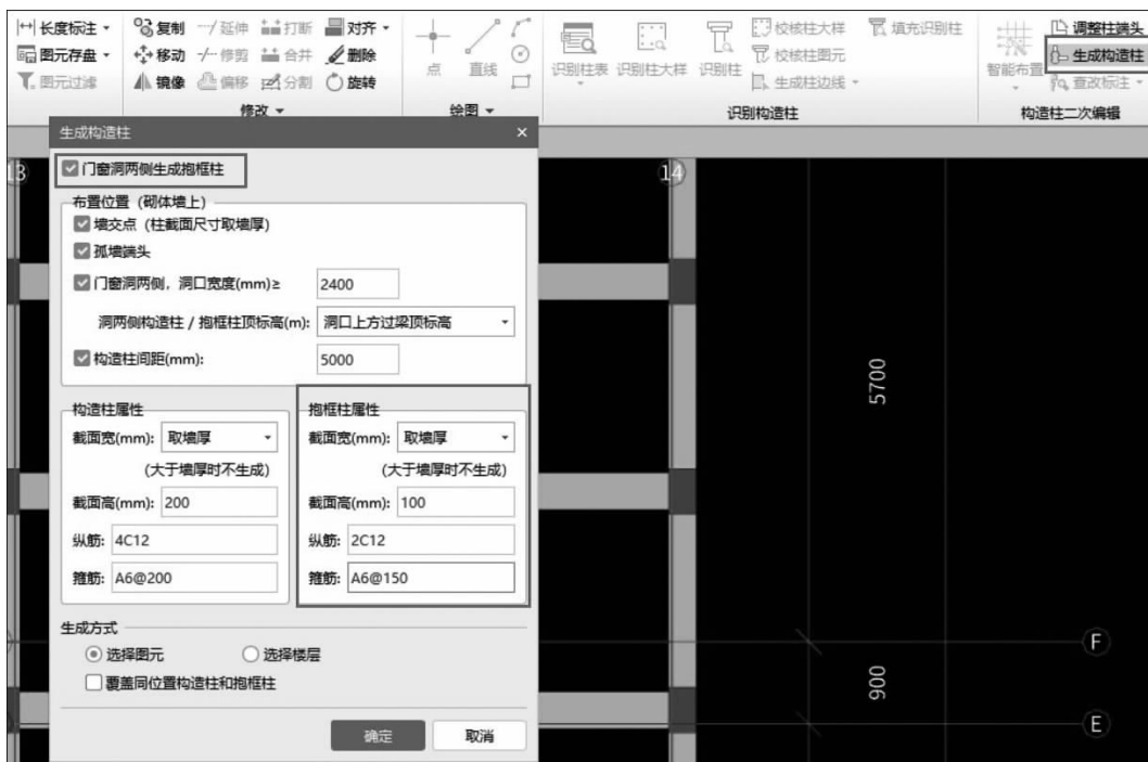
图 1-25 自动生成构造柱优化
