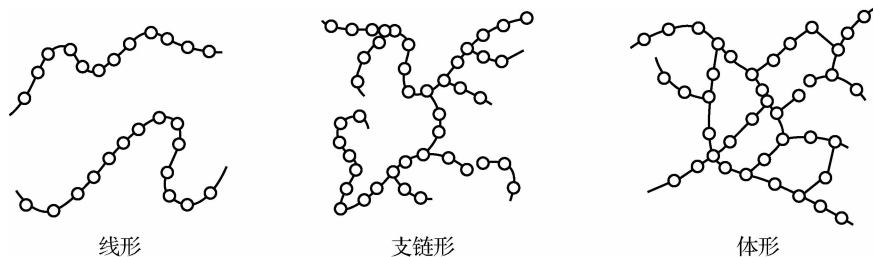
图 1-4 聚合物分子链结构示意图
