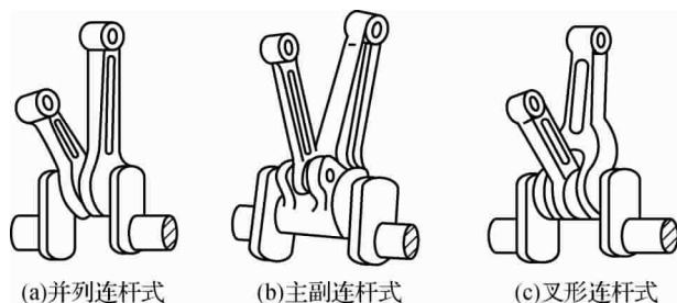
图 2-33 V 形发动机连杆的结构示意图
