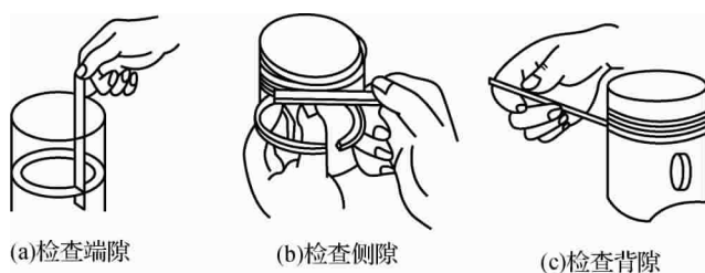
图 2-55 活塞环的三隙检查
