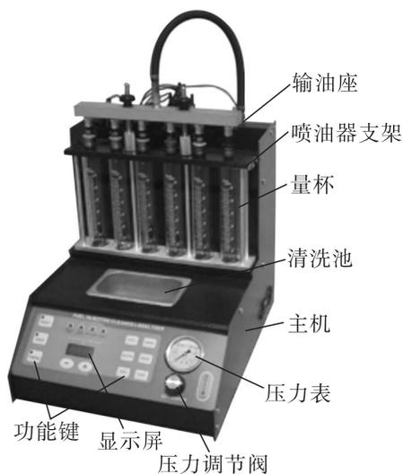
图 1-10 喷油器清洗检测仪器
