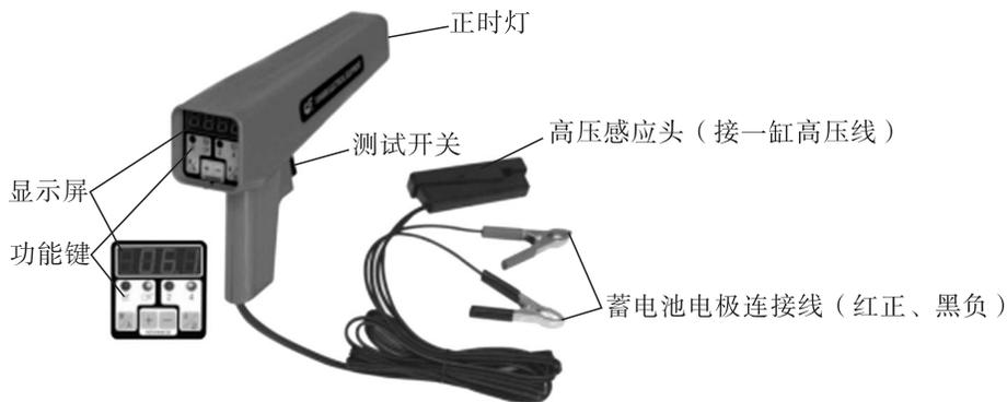
图 1-11 点火正时测试仪
