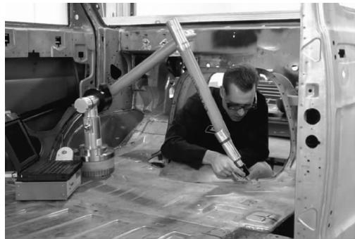
图 0-7 关节臂测量机
