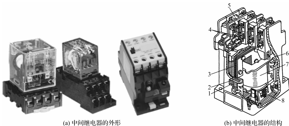
图 1-10 中间继电器的外形及结构
