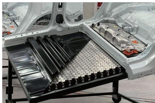
图 1-6 特斯拉结构化电池组封装技术
