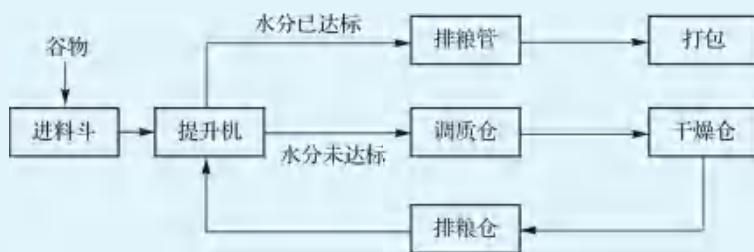
图 1-2 谷物烘干系统工艺流程
