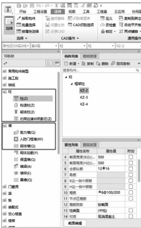
图 1-2 构件墙、柱的拆分
