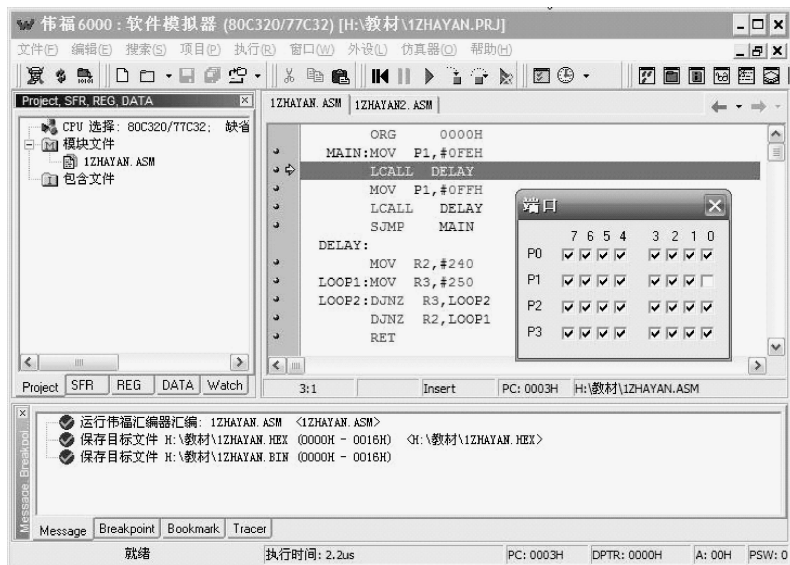
图 1-22 “眨眼”的 LED 程序仿真图(字节操作)
