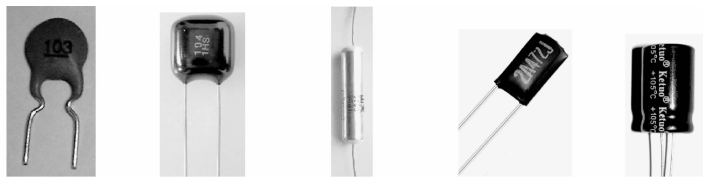
(a)陶瓷电容器 (b)云母电容器 (c)纸介电容器 (d)涤纶电容器 (e)电解电容器
