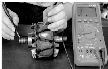
(b)绕组与铁心的绝缘性
