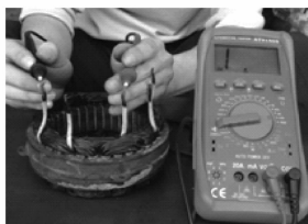
(b)检测绕组间的绝缘性
