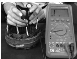
(b)检测绕组间的绝缘性
