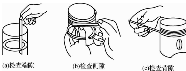
图 2-55 活塞环的三隙检查
