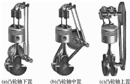
图 3-4 凸轮轴布置位置不同的配气机构
