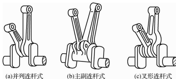
图 2-33 V 形发动机连杆的结构示意图
