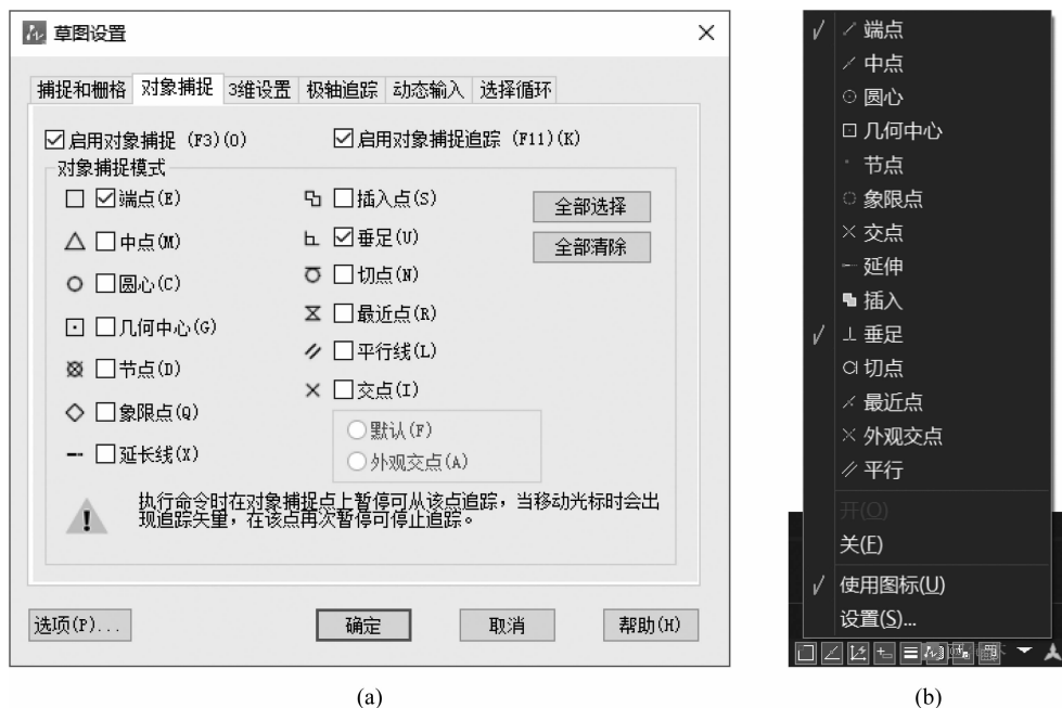
图 1-7 设置端点、垂足对象捕捉
