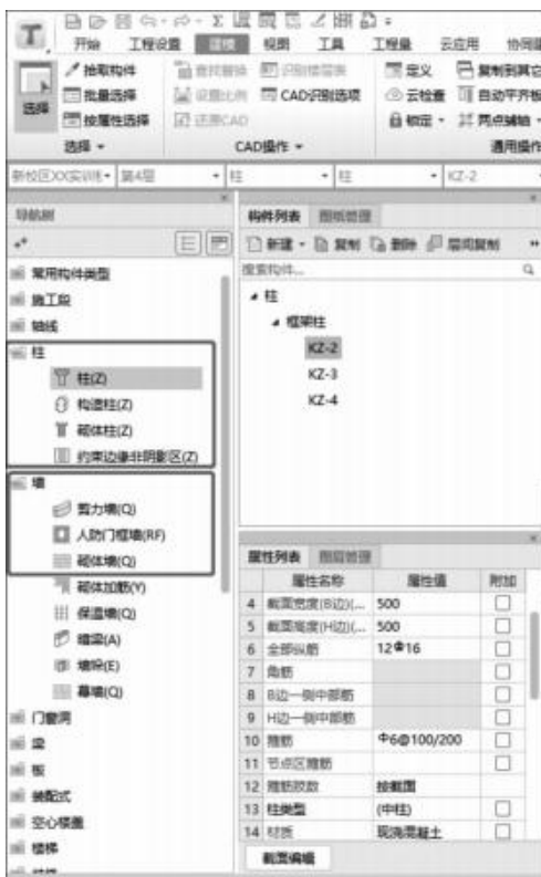
图 1-2 构件墙、柱的拆分
