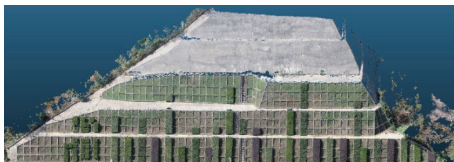
图 7-10 边坡建模效果
