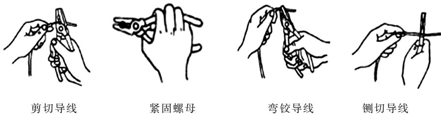
图 2-6 钢丝钳的使用方法
